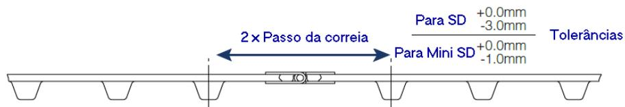
Em alguns para garantir o passo é necessária a eliminação de um dente. Os extremos serão cortados conforme o tamanho das emendas escolhidas. Este dente a menos (figura 5ª) não compromete o funcionamento, entretanto não recomendamos este procedimento quando se utilizam polias dentadas com 12 ou menos de 12 dentes.
