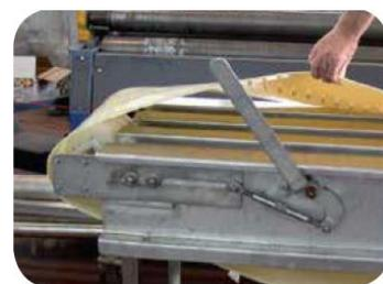
Dispositivo de acionamento rápido na posição de abertura
