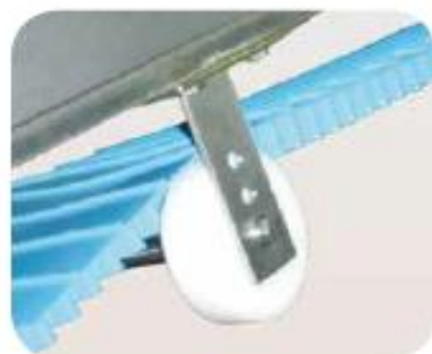
Rodas de apoio no tramo inferior
